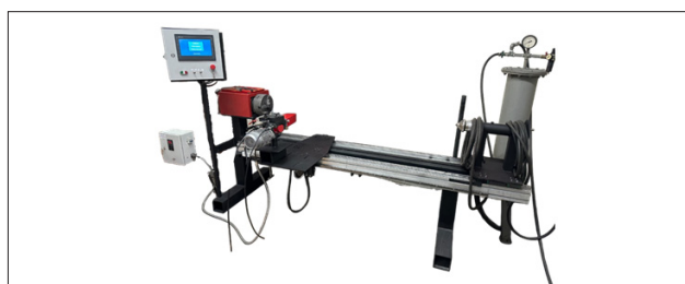
Рис. 11. Универсальная установка для сварки, наплавки и напыления, ВИМ, 2025 г.
