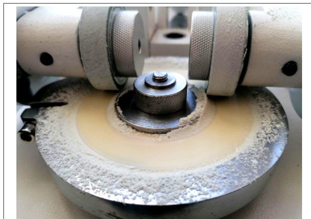
Рис. 3. Воздействие абразивных дисков на образец во время проведения исследования
