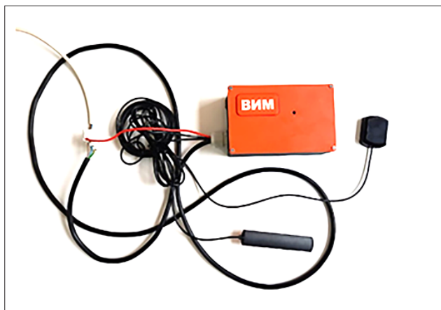
Рис. 1. Диагностическое устройство по мониторингу технического состояния СХТ через CAN -шину
