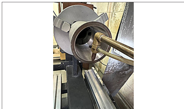
Рис. 13. Процесс восстановления внутренней поверхности чугунной гильзы методом ХГДН на универсальной установке
