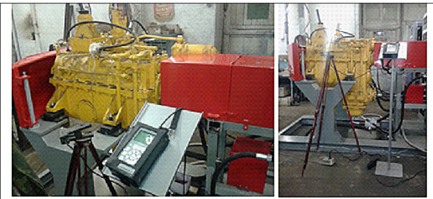
Рис. 6. Процесс оценки уровня звука при обкатке КПП К-701 на стенде КИ-28340 с применением виброшумомера ШИ-01В Fig. 6. The process of assessing the sound level during the running of the K-701 gearbox on the KI-28340 stand using the ShI-01V vibration noise meter
