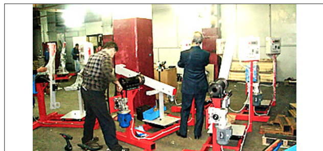
Рис. 6. Серийный выпуск автоматических установок на частотных преобразователях: а – автоматические установки TOM-14 для деталей типа «вал»; б – автоматические установки TOM-17 для восстановления отверстий
